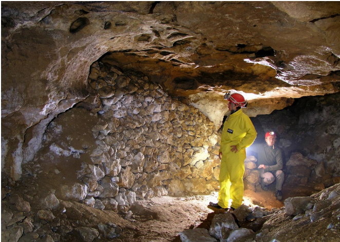
Illustration 66 – Mur de stériles dans la grotte-mine du Piei, Lagnes, Vaucluse. Les différences avec une vraie mine ne sont pas perceptibles pour les ouvriers qui ont exploité les remplissages riches en fer de la grotte.
